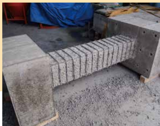
供試体打設製作状況 (かぶりコンクリートの研り)
