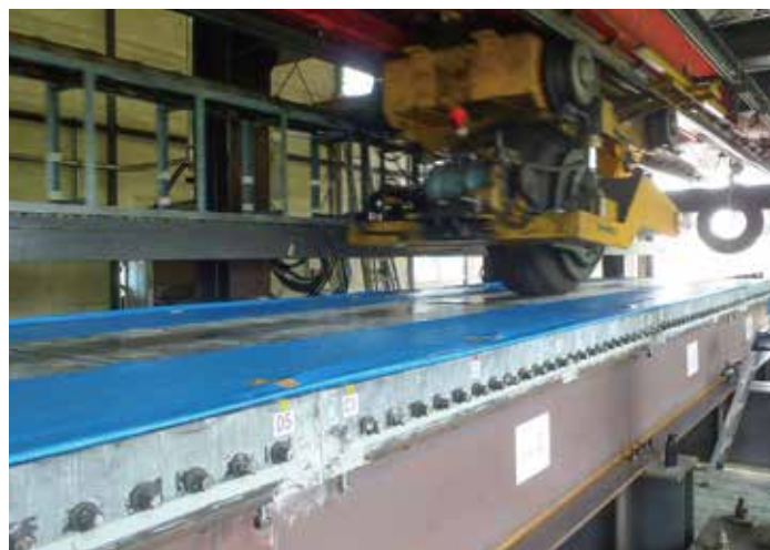
輪荷重走行試験状況
