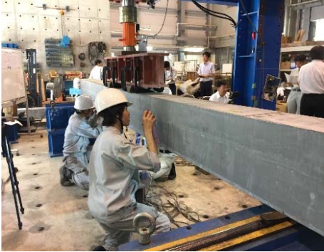
ひび割れ確認状況
