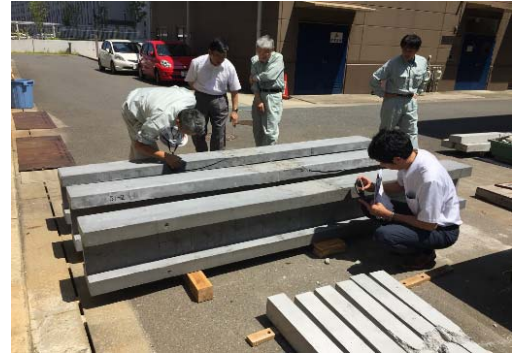
載荷試験後の せん断試験供試体
