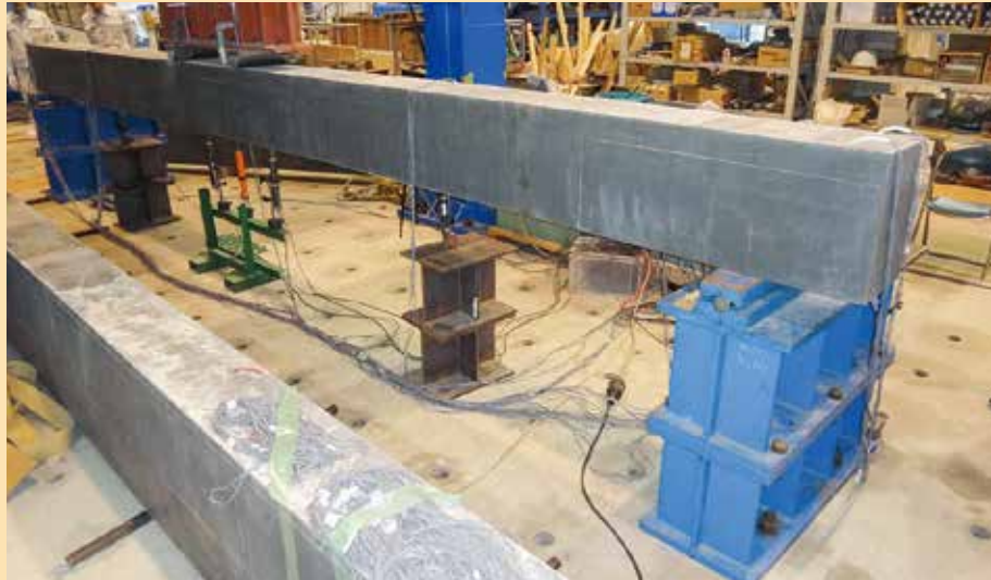
梁供試体のセット状況
