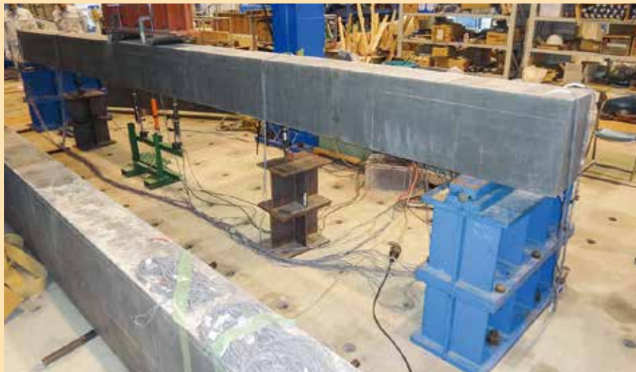
梁供試体のセット状況
